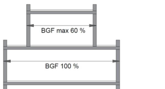
Skizze 5: Dachgeschoß – Definition über Bruttogeschoßfläche
